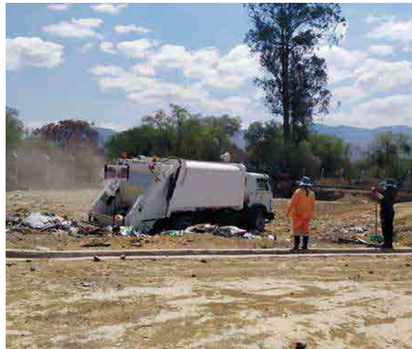
Descarga de Desecho dentro la zanja, supervisada por los operadores del servicio
