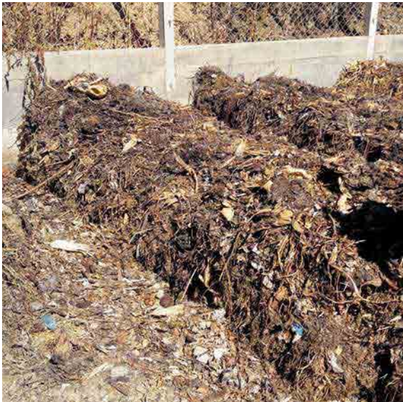
Aplicación de material estructurante para el armado de pilas
